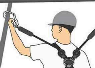
Verbindungselement für eine doppelte Befestigung an der Rückenöse des Auffanggurtes
